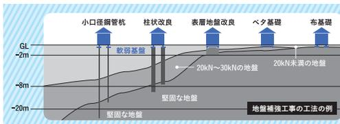
地盤の強さに応じて、地盤補強工事が必要となる場合があります。堅固な地盤が深い位置にある場合は、土中を柱状に改良したり、鋼管の杭を施工するなどして、建物の荷重を支持層まで伝えます。
