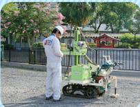
一建設では全棟の建築候補地を着工前に専門業者がチェック。不同沈下対策が必要な場合は鋼管杭を地盤に打ち込むなど、事前に対策を講じるほか万一損害が生じた場合には第三者等で保全できる体制を取っています。
