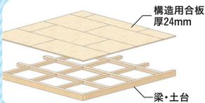
1階と2階の床面には厚さ24mmの合板を敷く剛床工法を採用。床が一つの面として家全体を一体化することで、横方向、水平方向の揺れに非常に強い構造を実現しています。
