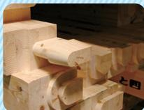
一建設では事前に工場で構造木材の切断・加工を施すプレカットシステムを採用。コストの削減や工期の短縮化を実現しています。また現場でゴミや騒音の発生を抑制し、地域にやさしい家づくりを実現しています。
